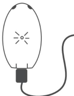
2. Dès que la fonction de charge démarre, le voyant à l'arrière du boîtier clignote en rouge une fois par seconde. Le sinus Body est maintenant en mode de charge. Lorsque la batterie est chargée, le voyant lumineux passe au vert et clignote toutes les 12 secondes. Le sinus Body est désormais chargé et allumé.
