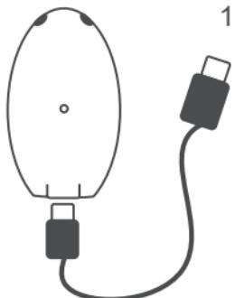
1. Le sinus Body doit être chargé avant d'être porté pour la première fois. Prenez le câble de charge fourni et branchez-le dans sinus Body. Branchez ensuite l'autre extrémité du câble dans une prise USB appropriée d'une prise secteur ou d'un appareil avec une alimentation (par exemple un ordinateur).
