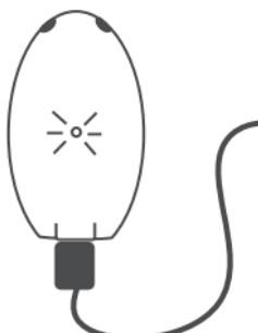
2. Sobald die Ladefunktion startet, blinkt das Licht auf der Rückseite des Gehäuses einmal pro Sekunde rot auf. Nun befindet sich der sinus Body im Lademodus. Wenn der Akku aufgeladen ist, wechselt das Lichtsignal auf grün und blinkt alle 12 Sekunden auf. Nun ist der sinus Body aufgeladen und eingeschaltet.
