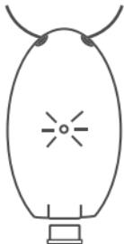
4. Gardez les connexions sèches et propres. Pour protéger la prise USB de l'appareil sinus de la poussière, des salissures et de l'humidité, veuillez utiliser la couverture fourni pour la prise USB. Il suffit d'insérer la couverture tout droit dans la prise USB et de ne l'enlever que lorsque l'appareil doit être rechargé.
